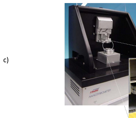
Slika 8.10 a) Tribometar za ispitivanje na povišenim temperaturama 20-1000 °C; b) tribometar za ispitivanje u vakumu; c) mikro (nano) tribometar
